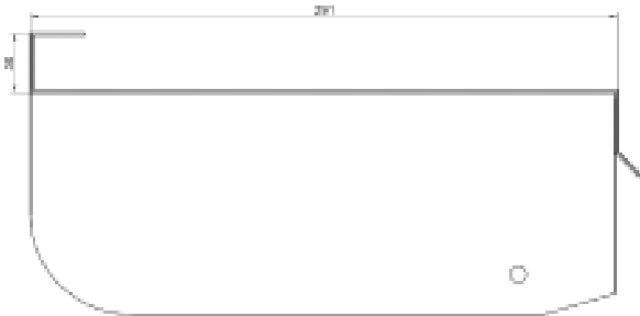
Soporte para techo sin elevación Longitud de soporte = ancho de chasis + 120 mm 019 020 02181
